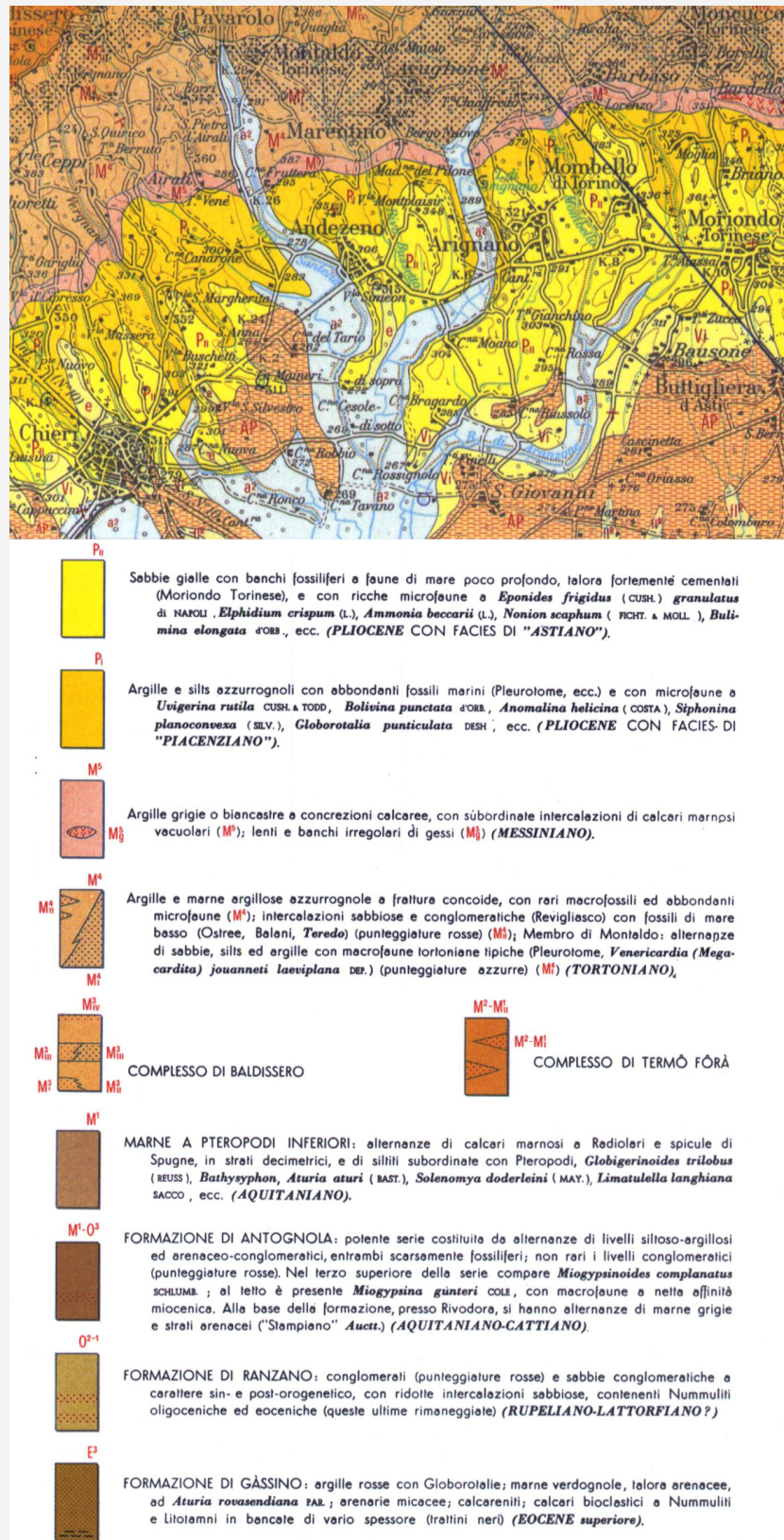
Figura 2.2 - Caratteristiche geologiche dell'area (da Carta Geologica d'Italia)
