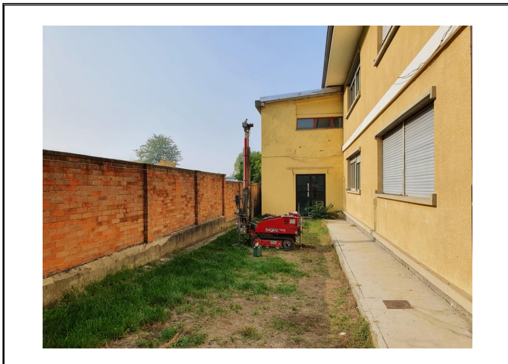
Foto 3: Posizionamento prova penetrometrica dinamica CPT 3.
